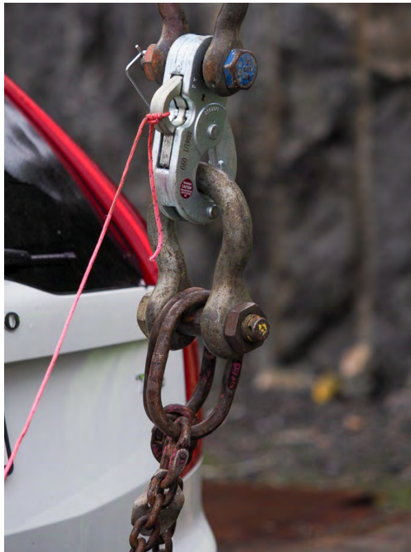
Figur 9. Släppkrok, kättingar och dragsnöre för släpp från kran.
