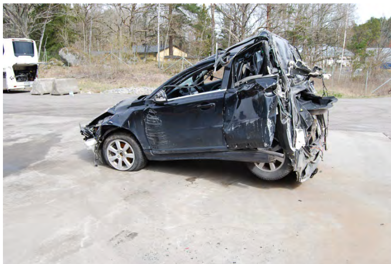
Figur 35. Extremt kraftig deformation vid bakändeskollision.
