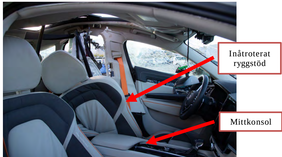
Figur 33. Mycket kraftig deformation samt ryggstöd som roterat inåt.
