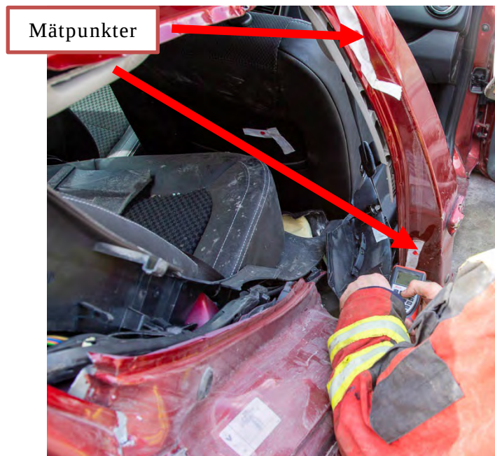
Figur 12. Avståndsmätning med lasermätare.
