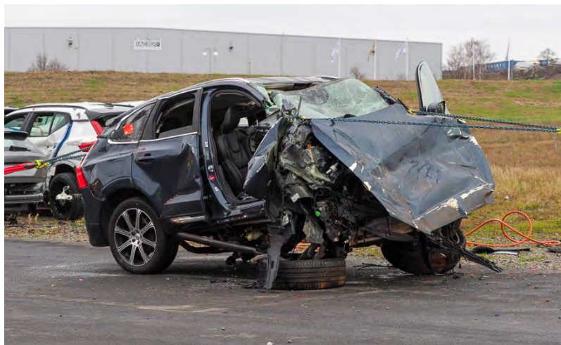
Figur 51. Kättingar kopplade för drag i A- och D-stolpar.
