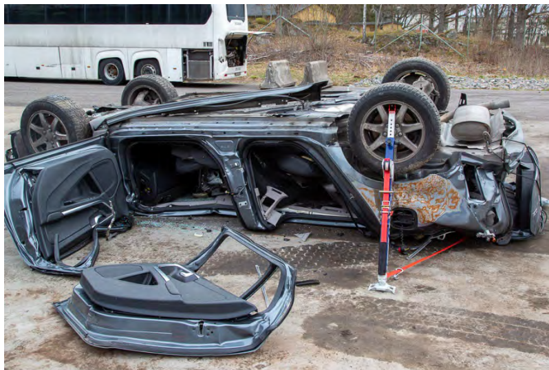
Figur 38. Extrem deformation vid bil på tak.
