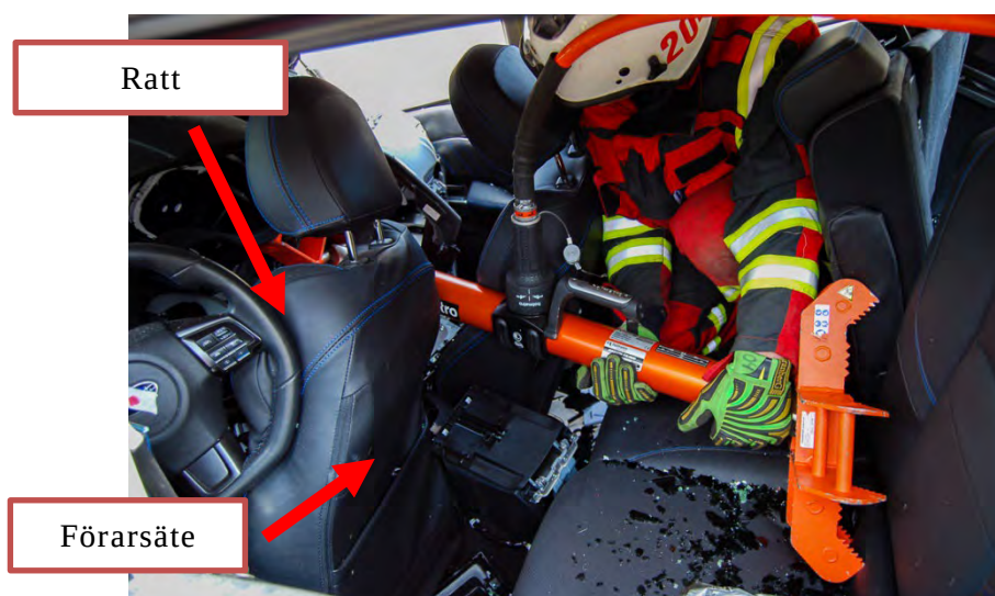
Figur 29. Frontalkollision med torpedvägg och instrumentpanel intryckt.
