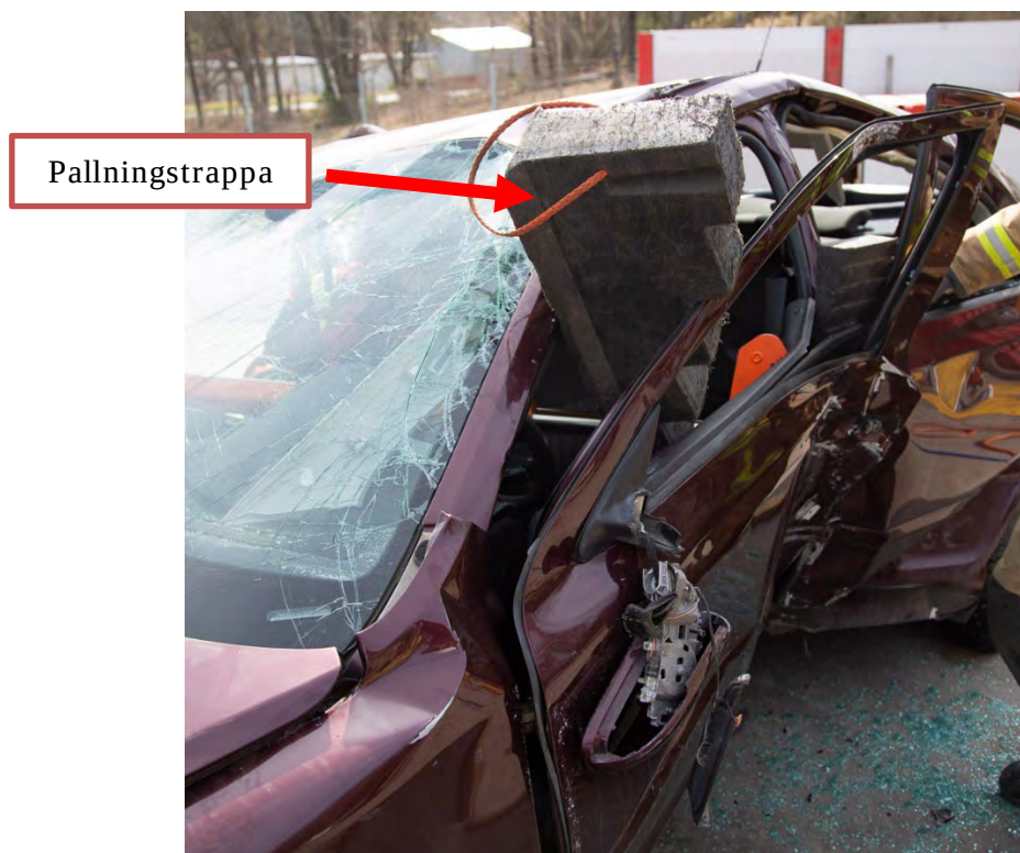
Figur 43. Stabilisering som skydd mot återfjädring.
