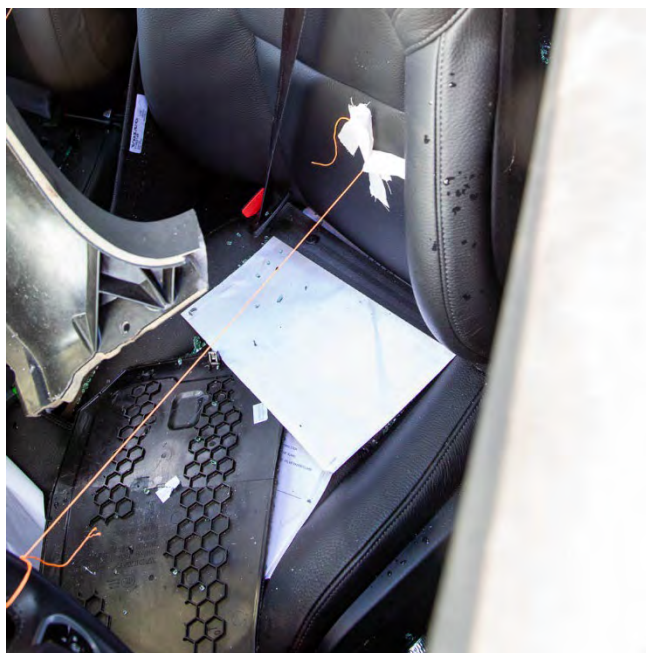
Figur 13. Rörelseindikering med tejpat murarsnöre, med tydlig indikation på att avståndet har ökat.
