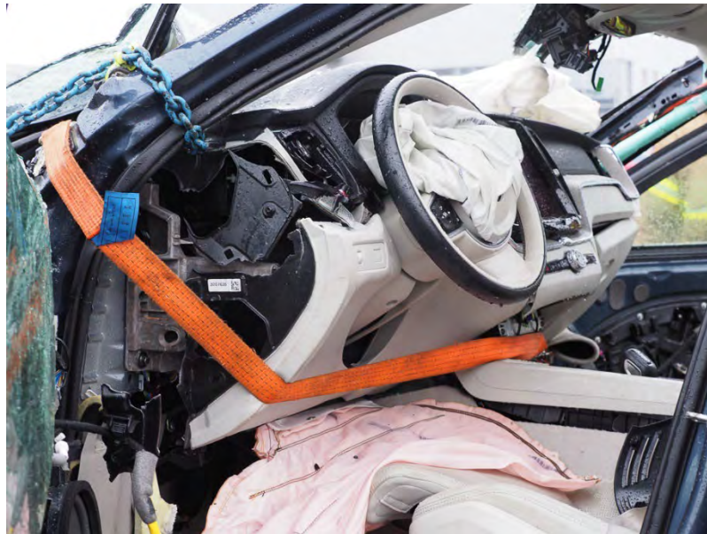
Figur 49. Spännband kopplat för att säkra instrumentpanel. Kan även användas med hydraulverktyg.
