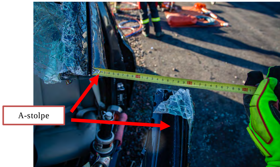
Figur 23. A-stolpe som skjutit ut 20 cm vid klipp.
