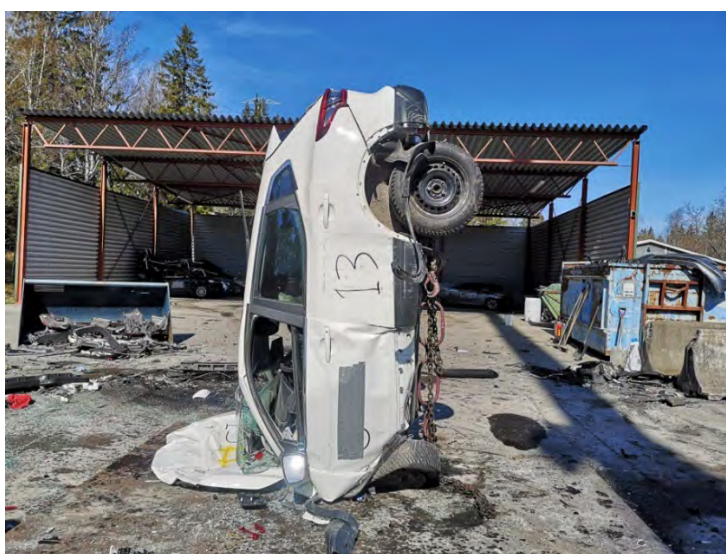
Figur 28. Stolpar och trösklar relativt intakta, instrumentpanelen intryckt.
