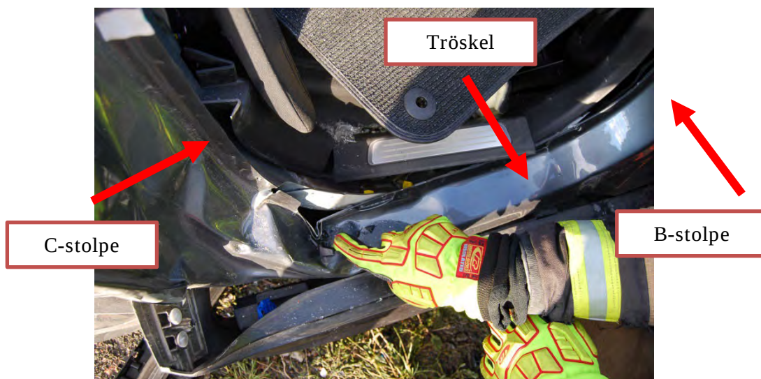
Figur 36. Separation i punktsvetsning.
