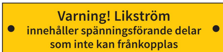
Figur 3. Exempel på utmärkning av dolt förlagd kabel 4 .
