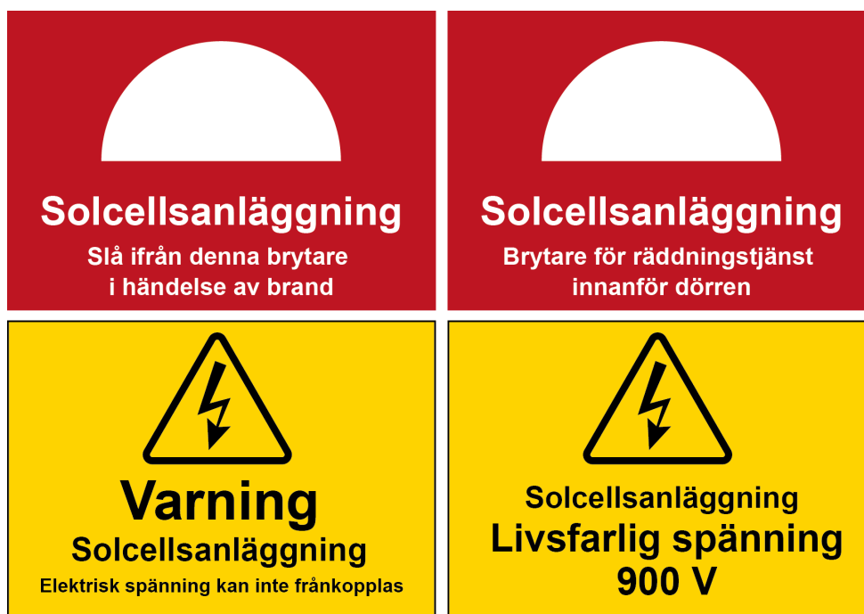
Figur 2. Exempel på skyltning för brytare och spänningsförande delar.
