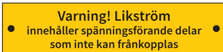
Figur 3. Exempel på utmärkning av dolt förlagd kabel 4 .
